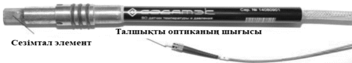
Сурет 1.12 – “Sedatec” компаниясы шығарған БТ негізіндегі температураның талшықты-оптикалық сенсорларының сыртқы пішіні
