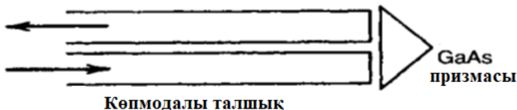
Сурет 1.13 – Жартылай өткізгіш шекарасының жылжуын қолданатын температура сенсоры
